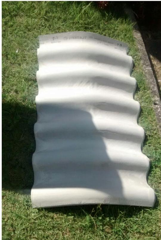
**Figura 15:** Telha de fibrocimento a ser utilizada. (Fonte: Dos Autores 2016)
